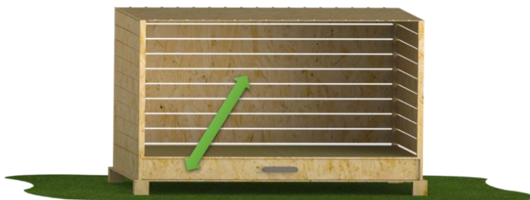
Figura 11 – Parte Interior do Compostor de paletes e gaveta Fonte: Elaboração própria
